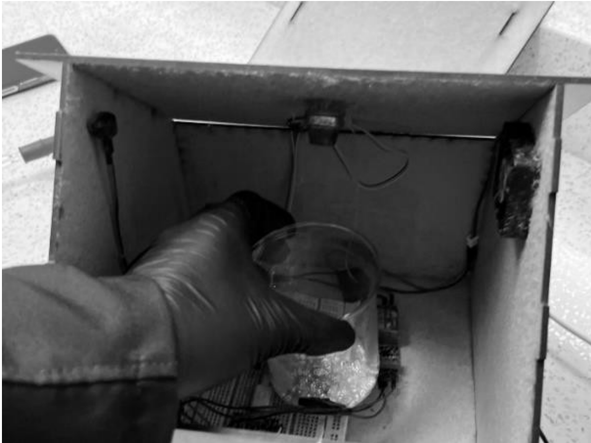
Figura 14 Activación del buzzer al detectar gas inflamable
