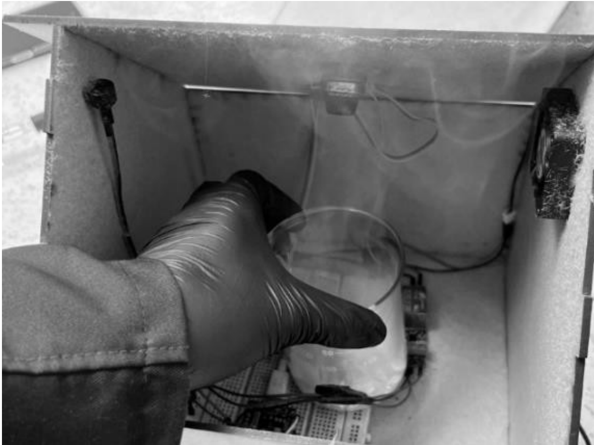
Figura 16 Activación del ventilador al superar umbral crítico
