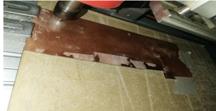
Figura 7. Proceso de corte de la placa PCB.
