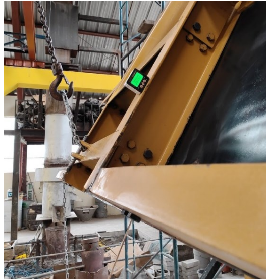
Figura 40. Colocación del péndulo a 30° Elaborado por: Los Autores
