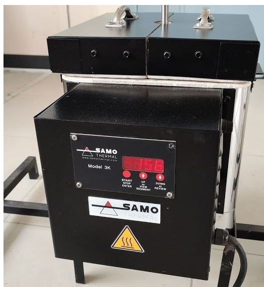
Figura 16. Horno eléctrico de mufla modelo 4-9 Samothermal Elaborado por: Los Autores
