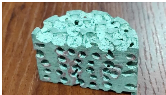
Figura 33. Probeta seccionada de 5mm de tamaño de poro Elaborado por: Los Autores
