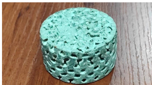
Figura 42. Probeta ensayada 5mm tamaño de poro Elaborado por: Los Autores
