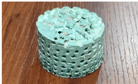
Figura 30. Espumas de aluminio de celda abierta de 3mm de tamaño de poro Elaborado por: Los Autores
