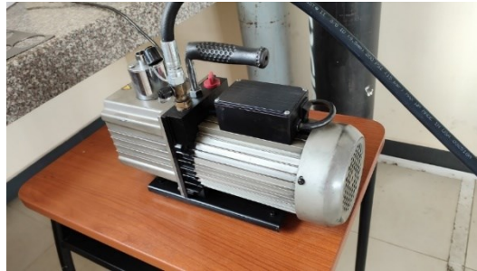
Figura 17. Bomba de vacío QUALITY Model QVP 800. Elaborado por: Los Autores
