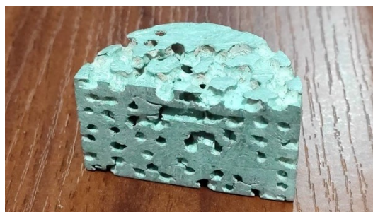
Figura 32. Probeta seccionada de 3mm de tamaño de poro https://tesla.puertomaderoeditorial.com.ar/
