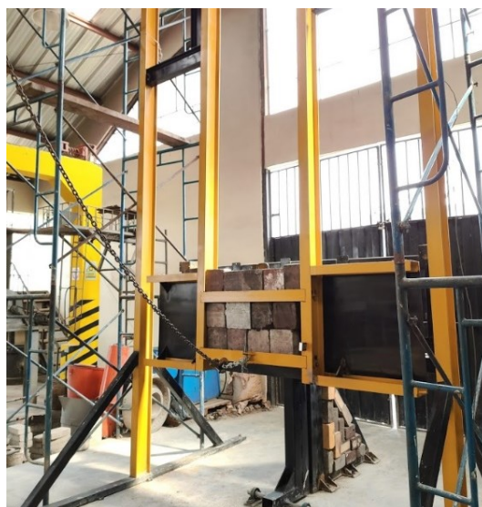
Figura 39. Péndulo de impacto para ensayo de compresión dinámica
