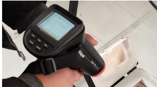
Figura 21. Pirómetro para la medición de la temperatura del molde Elaborado por: Los Autores
