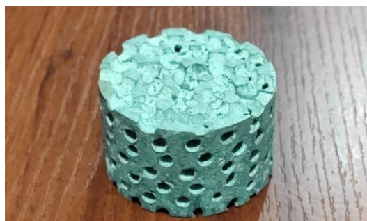
Figura 31. Espumas de aluminio de celda abierta de 5mm de tamaño de poro Elaborado por: Los Autores
