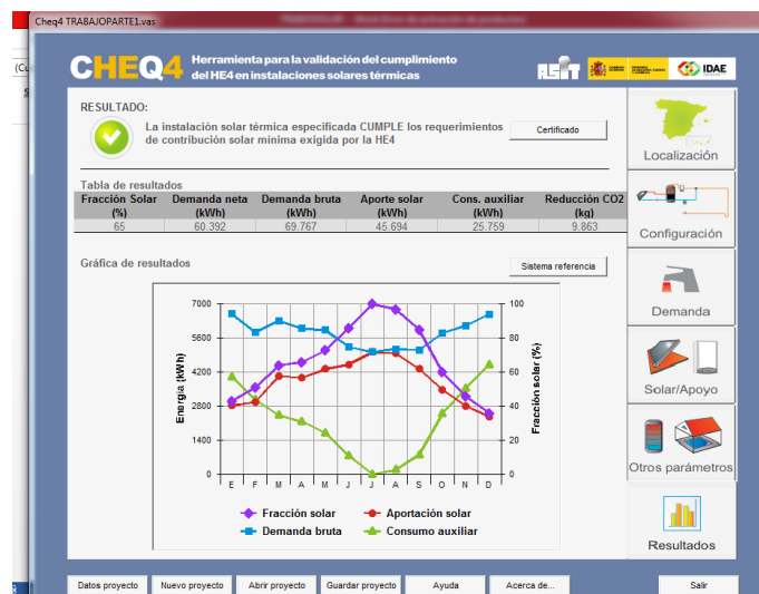
Figura 3 Resultados de CHEQ4 correspondiente a la verificación preliminar de la instalación, mostrando la fracción solar anual obtenida y el indicador de cumplimiento del CTE-HE4
