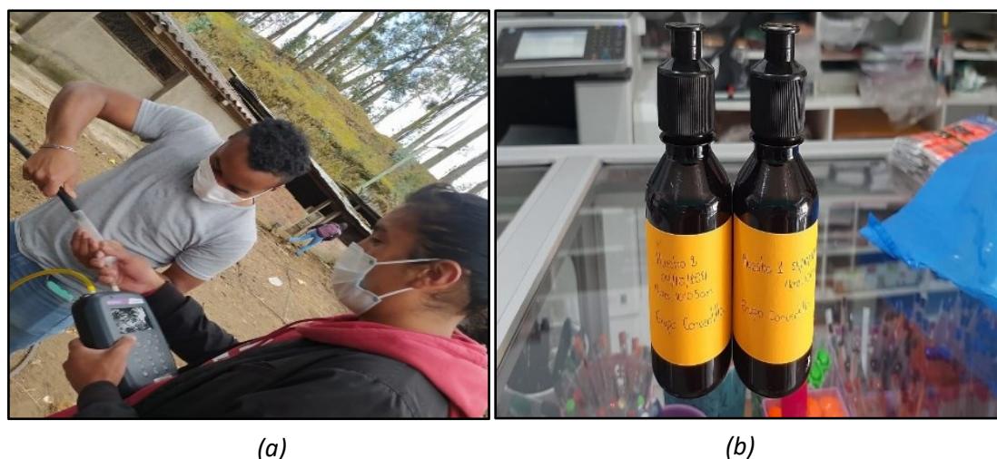
Figura 2. (a) Medición de la concentración de metano y dióxido de azufre presente en el biogás; (b) Muestras de biol para el laboratorio.
