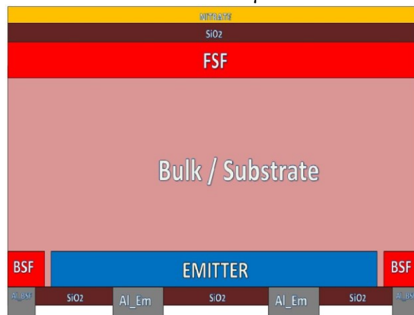
Fig. 3 Elemento de simetría- dos contactos de 100 \mu\text{m} en el emisor.
